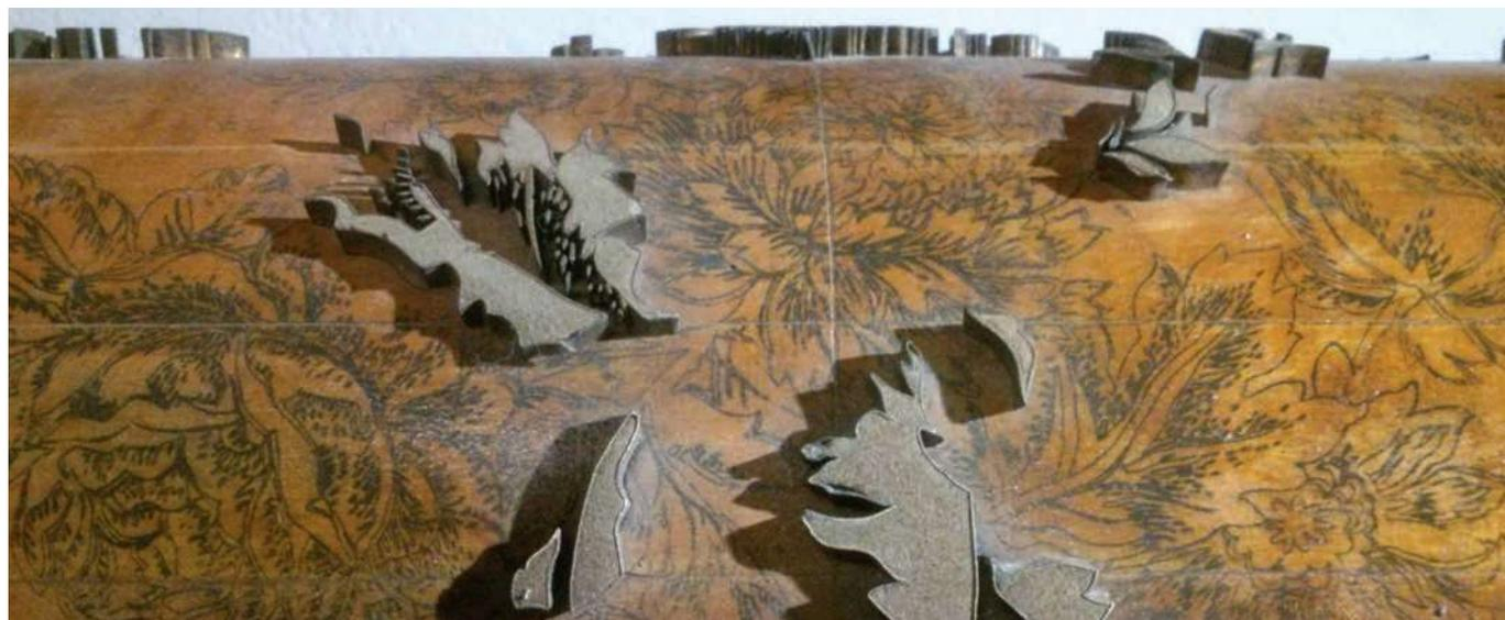
L'elaborata struttura di un cilindro in rilievo in legno e metallo per disegno a molti colori
